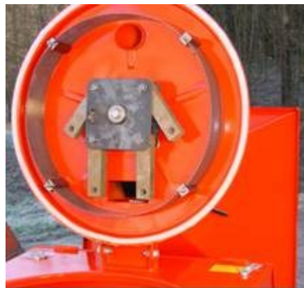
Zahvaljujući novoj konstrukciji (veliko sito sa specijalnim mehanizmom za mlevenje) postiže se visok radni učinak. Troškovi rada su niski zahvaljujući 4x okretnim sečivima
